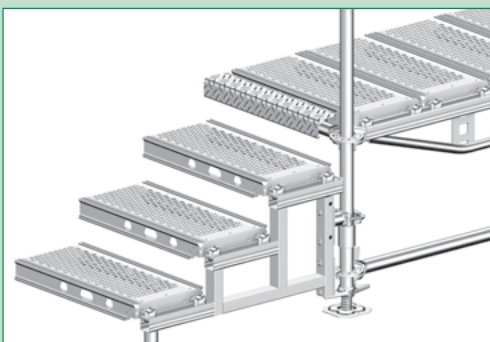
Modultreppe an Gerüst
